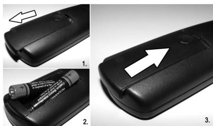
**Remarque:** Retirez les piles de la télécommande lorsqu'elle n'est pas utilisée durant une longue période. Sinon une fuite possible des piles peut l'endommager. Le rayon d'action est approximativement de 7 m / 23 pieds.
