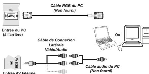
*Remarque: Vous devez utiliser les entrées audio du câble de connexion AV latéral (ROUGE&BLANC) pour activer la connexion sonore lors de la connexion d'un périphérique à votre téléviseur au moyen d'un PC.*
